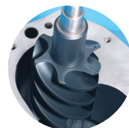
Beschichtete Rotoren und Gehäuse sorgen für sicheren Betrieb und verlängern die Lebensdauer
