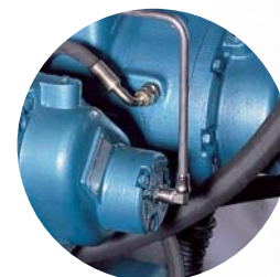
Schubausgleichskolben auf der 1. und 2. Stufe verteilen die Lagerschublasten und verlängern dadurch die Standzeiten.
